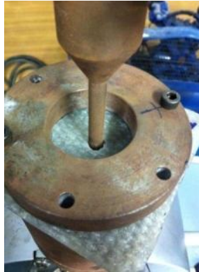
Figure 9 ลักษณะการทะลุเสียหายของชิ้นงาน
