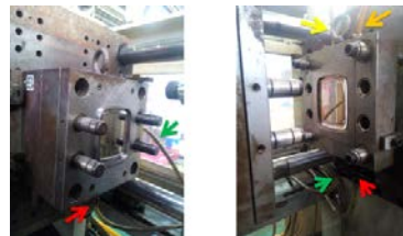
Figure 2 แม่พิมพ์ฝากล่อง (ก) ด้าน Cavity (ข) ด้าน Core
