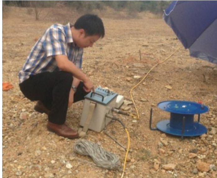
Figure 3 การวัดค่าความต้านทานไฟฟ้า ด้วยเครื่องมือ IRIS R1 Plus
