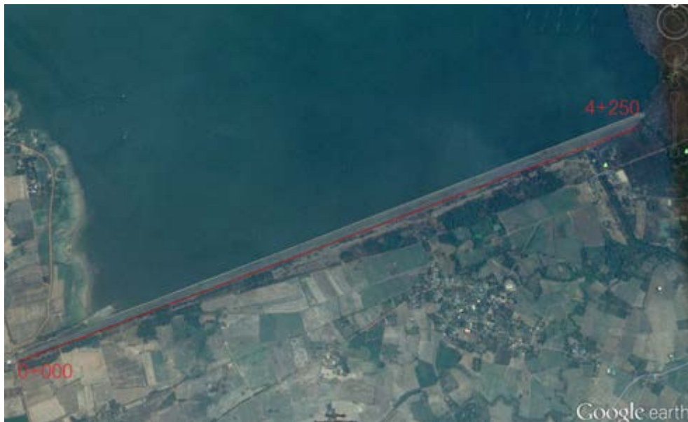
Figure 7 การวางแนวสำรวจขนานกับสันเขื่อน ยาว 4,250 เมตร
