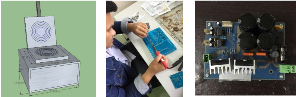
Figure 2 การออกแบบโครงสร้างเตาและวงจรเหนี่ยวนำความร้อน
