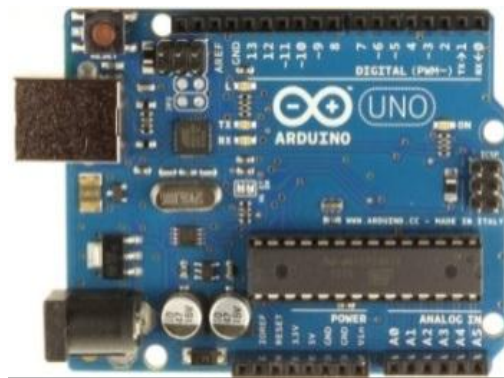
ภาพที่ 5 บอร์ดไมโครคอนโทรลเลอร์ Arduino UNO R3 (ศิริวรรณ เอี่ยมบัณฑิต, 2557)
