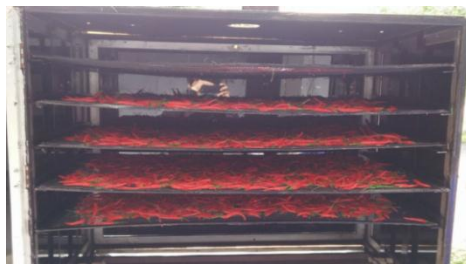
ภาพที่ 9 การอบแห้งพริกชี้ฟ้าแบบลมร้อน
