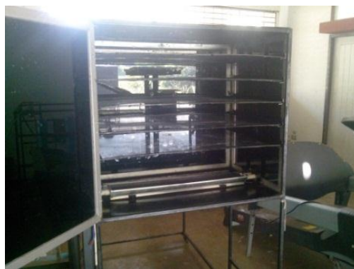
ภาพที่ 5 ตู้อบที่ได้ทำการปรับปรุงชั้นวางเป็น 5 ชั้น
