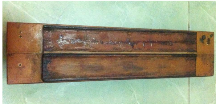
ภาพที่ 7 พิกเจอร์ช่วยในการจับยึดชิ้นงาน
