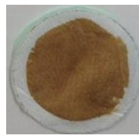
ภาพที่ 10 ตัวอย่างอนุภาคควินบนแผ่นกรองจากการสุ่มเก็บ
