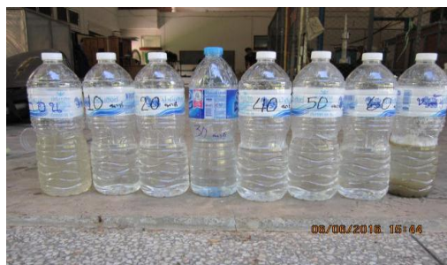
ภาพที่ 10 ตัวอย่างน้ำที่ผ่านการบำบัดแล้ว เนื่องจาก น้ำก่อนบำบัดและ หลังบำบัด 10-60 นาที
