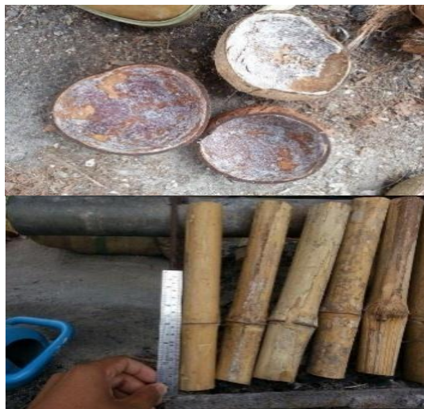
ภาพที่ 2 เศษวัสดุที่เหลือใช้จากการเผาข้าวหลามสำหรับผลิตเชื้อเพลิงถ่านอัดแท่ง
