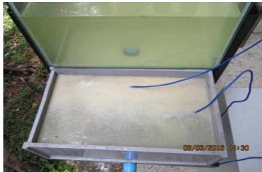
ภาพที่ 7 เกิดปฏิกิริยาออกซิเดชันขึ้นทำให้เกิดฟองลอยขึ้นมาพร้อมกับตะกอนที่แยกตัวออกจากน้ำ
