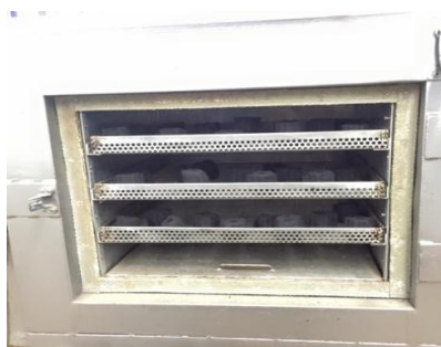
ภาพที่ 7 การลดความชื้นแก่เชื้อเพลิงถ่านอัดแท่ง
