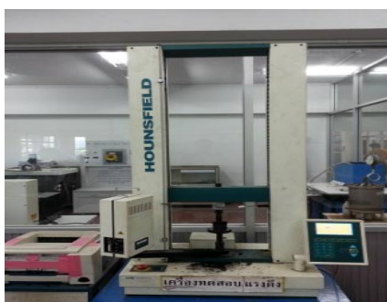
ภาพที่ 9 การทดสอบหาค่าความแข็ง ด้วยเครื่องทดสอบแรงดึง
