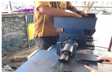
ภาพที่ 6 การอัดขึ้นรูปเชื้อเพลิงถ่านอัดแท่ง
