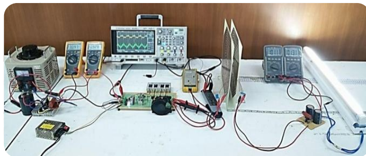
ภาพที่ 10 การส่งกำลังไฟฟ้าวไรสายใช้แผ่นวงจรพิมพ์ 2 ด้าน ขดตัวนำแบบแปดเหลี่ยม
