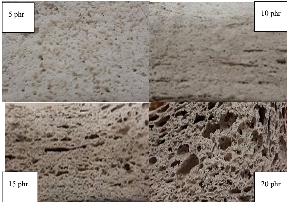
ภาพที่ 3 ลักษณะเซลล์ของฟองน้ำยางธรรมชาติที่ใช้สารตัวเติมร่วมระหว่างเปลือกกล้วย และรำสกัดน้ำมันในปริมาณต่าง ๆ
