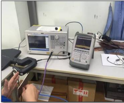
ภาพที่ 18 การทดลองสายอากาศเก็บเกี่ยวพลังงานจาก ไวเลสแลนที่ความถี่ 2.45 กิกะเฮิร์ตซ์
