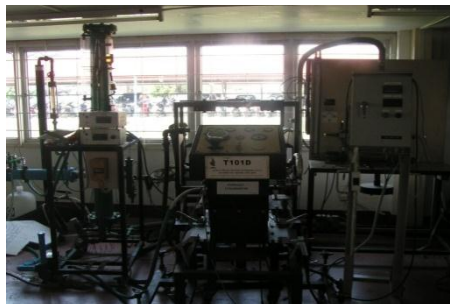
ภาพที่ 3 ชุดทดสอบสมรรถนะเครื่องยนต์ไฮดรอลิกไดนาโมมิเตอร์ T101D
