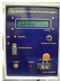
ภาพที่ 3 ชุดควบคุมการให้น้ำและบันทึกข้อมูลแบบต่อเนื่องที่ทำการพัฒนาขึ้น
