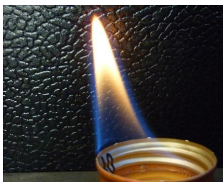
ภาพที่ 6 การทดสอบเปลวไฟจากการเผาไหม้ของน้ำมันเชื้อเพลิงที่กลั่นได้ที่อุณหภูมิ 80-92 °C
