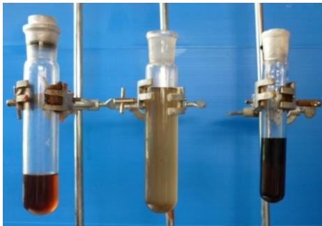
ภาพที่ 7 ของเหลวที่กลั่นได้ในช่วงอุณหภูมิ 80-92, 92-120 และ 120-200 °C ตามลำดับจากซ้ายไปขวา
