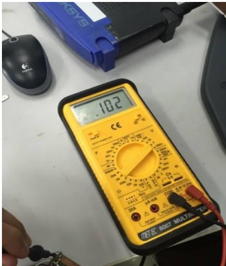
ภาพที่ 19 ผลการวัดแรงดันไฟตรงด้านเอาต์พุต
