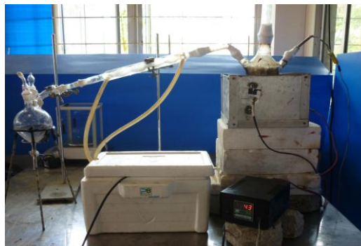
ภาพที่ 3 ชุดทดสอบกระบวนการกลั่นของเหลวทาร์
