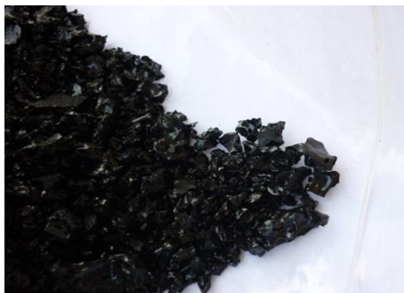
ภาพที่ 8 ลักษณะของของแข็งที่ได้หลังจากกระบวนการกลั่นของของเหลวทาร์
