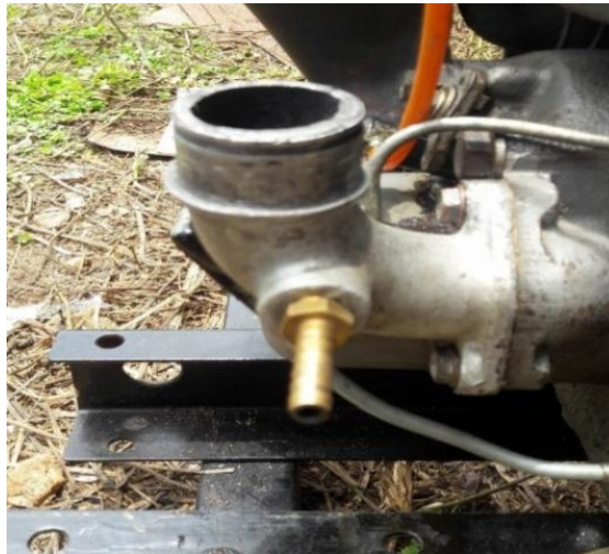
ภาพที่ 4 การติดตั้งท่อไอดีแบบ T-Type
