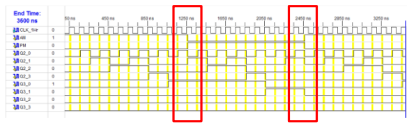
ภาพที่ 16 การจำลองการทำงานของวงจรมัลติเพล็กซ์แสดงผล AM-PM
