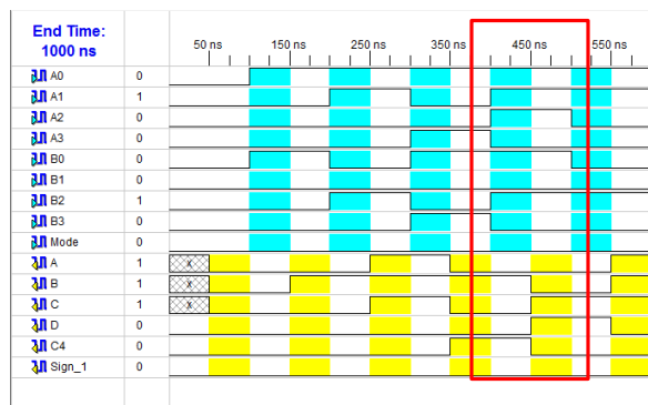
ภาพที่ 11 จำลองการทำงานของวงจรบวกเลขฐานสองเมื่อขา Mode = 0
