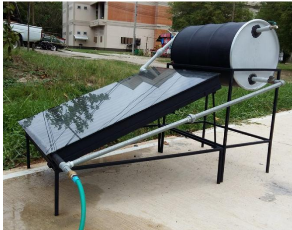
ภาพที่ 10 การทดสอบสมรรถนะของเครื่องทำน้ำอุ่นพลังงานแสงอาทิตย์แบบต้นทุนต่ำ
