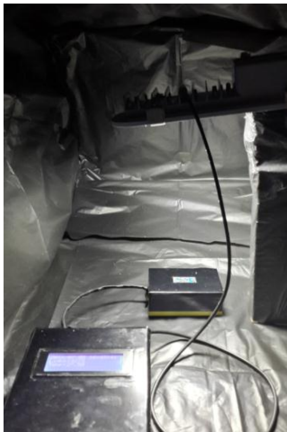
ภาพที่ 13 การทดลอง ในกล่องสี่ด้าปิดสนิท วัดและหาค่าอุณหภูมิและความส่องสว่างของแสง
