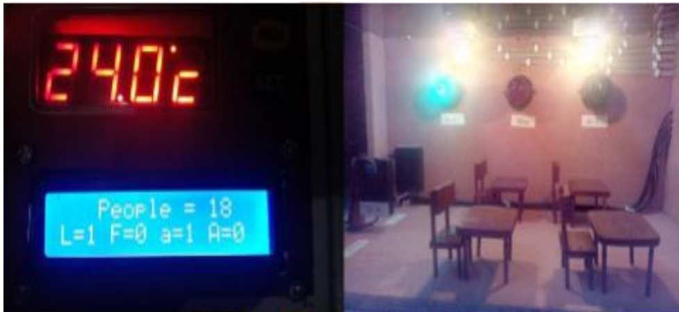
ภาพที่ 8 แสดงการทำงานของหลอดไฟเครื่องปรับ อากาศตัวที่ 1 และ 2 ทำงานเมื่อมีคนเข้ามาในห้องมากกว่า 15 คน และอุณหภูมิต่ำกว่า 25 องศาเซลเซียส
