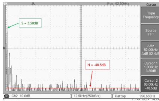
ภาพที่ 15 การวัดสัญญาณในเชิงความถี่เพื่อหาค่า SNR
