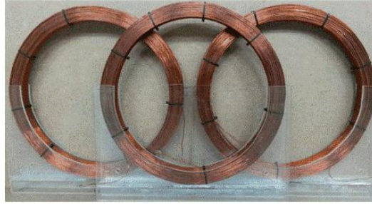
ภาพที่ 4 ลักษณะขดตัวนำด้านส่งและรับกำลังงาน
