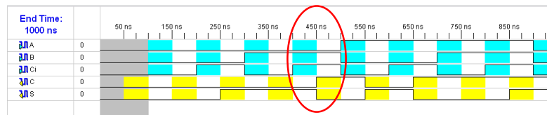
ภาพที่ 9 การจำลองการทำงานของวงจร Full Adder
