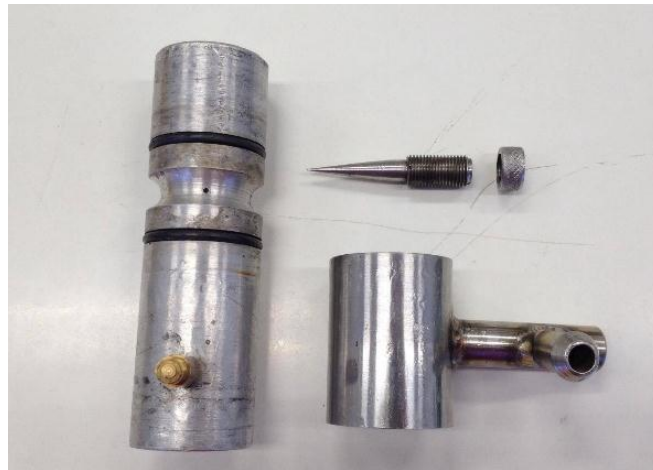
ภาพที่ 6 แสดงชิ้นส่วนต่างๆ ของคาร์บูเรเตอร์ก๊าซ
