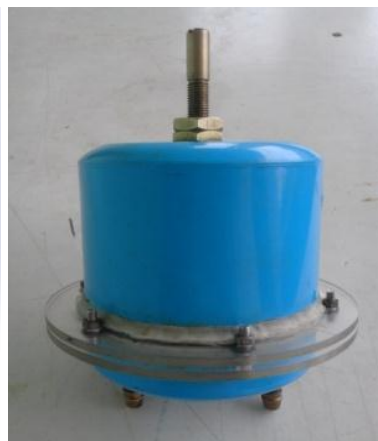
ภาพที่ 3 เครื่องปรับความดันก๊าซชีวภาพที่สร้างขึ้น
