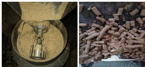
ภาพที่ 2 การทดลองอัดเม็ดฟาง
