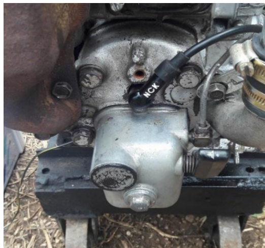
ภาพที่ 8 ฝาสูบที่ทำการใส่หัวเทียนเรียบร้อยแล้ว
