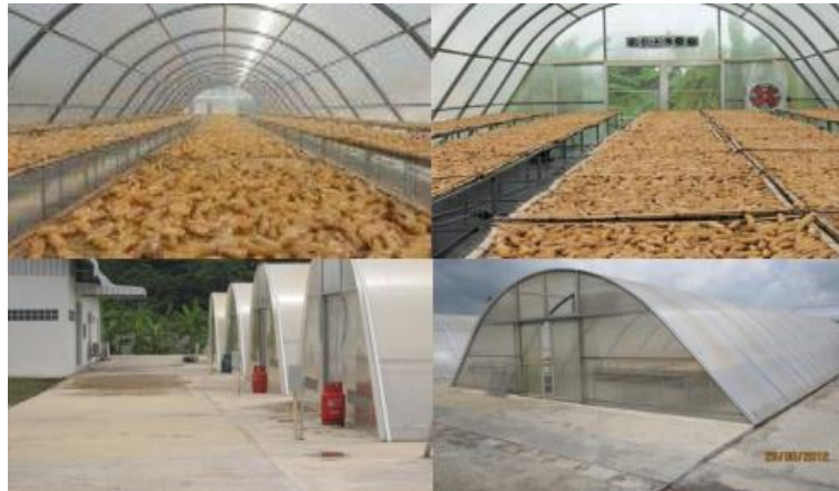
ภาพที่ 1 การประยุกต์ใช้พาราโบลาโดมในการอบกล้วยตากจิราพร (สิริจิต อุเจริญ, 2556)
