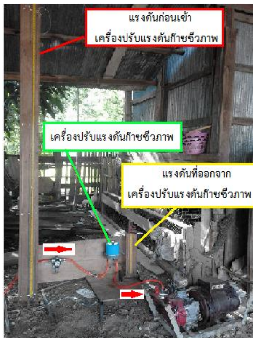
ภาพที่ 4 การทดสอบเครื่องปรับความดันก๊าซชีวภาพ
