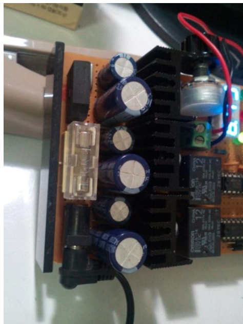
ภาพที่ 17 วงจรภาคจ่ายไฟ +9โวลต์, +12โวลต์, +1.25โวลต์ ถึง +9โวลต์
