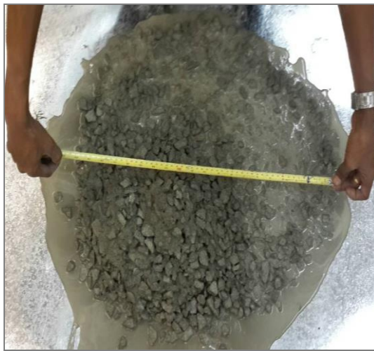
Figure 2 การไหลผ่านของคอนกรีต A2 (การแทนที่มวลรวมหยาบด้วยเศษแอสฟัลต์คอนกรีตปริมาณร้อยละ 50)
