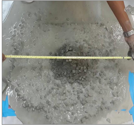
Figure 3 การไหลแผ่ของคอนกรีต B2(การแทนที่มวลรวมหยาบด้วยเศษแอสฟัลต์คอนกรีตปริมาณร้อยละ 50)
