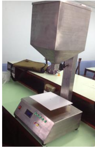
Figure 8 โครงสร้างเครื่องชั่งน้ำหนักและบรรจุข่าวกึ่งอัตโนมัติ
