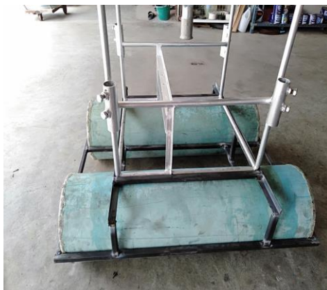
Figure 4 ติดตั้งท่อพีวีซีเข้ากับฐาน
