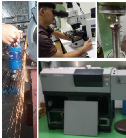
ภาพที่ 2 การทดสอบ Spark test, Materials Innovation Center ,Hardness test, Spectrometer
