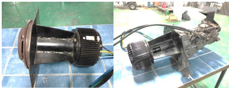
รูปที่ 4 การติดอุปกรณ์เชื่อมต่อเข้ากับมอเตอร์ไฟฟ้าต้นกำลังกับชุดเกียร์ และการติดตั้งเข้ากับตัวรถ
