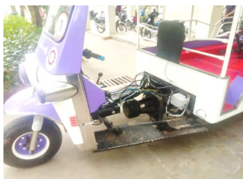
รูปที่ 3 การติดตั้งอุปกรณ์เชื่อมต่อต้นกำลังเข้ากับตัวรถตุ๊กตุ๊กจริงที่นำเครื่องยนต้ออกแล้ว
