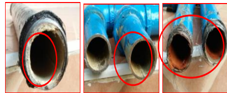
ภาพที่ 7 ความสัมพันธ์ระหว่างการตรวจเช็คภายในท่อ น้ำประปาที่ตัดมาทำการตัดท่อจากห้องน้ำชั้น 1 และ ชั้น 3
