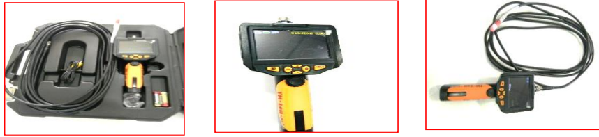
Figure 1 ความสัมพันธ์ระหว่างเครื่องมือกล้องที่ใช้ ตรวจสอบภายในท่อน้ำประปา Model: NST-2000
