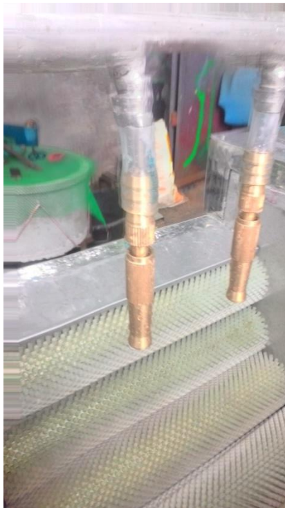
ภาพที่ 18-19 หัว Nozzle แรงดันน้ำและชุดวัดแรงดันน้ำ
