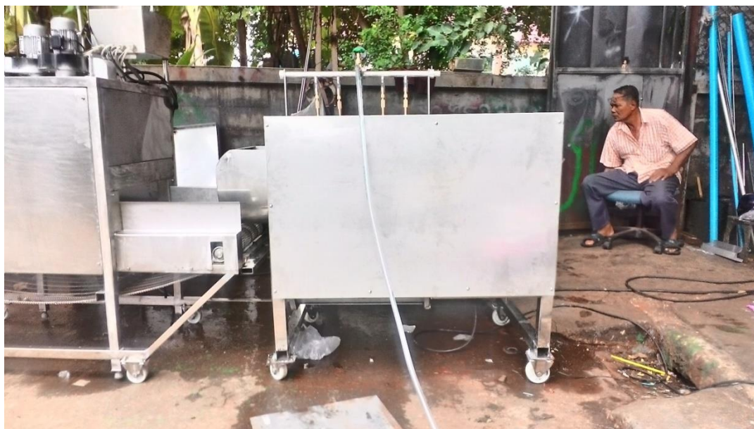
ภาพที่ 15 ภาพเครื่องล้างหัวมันเทศโดยใช้แรงดันน้ำ (ด้านหลัง)
