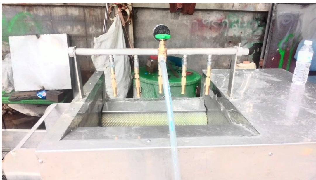
ภาพที่ 16 บริเวณจุดต่อน้ำเข้าเครื่อง (ด้านหลังเครื่อง)
