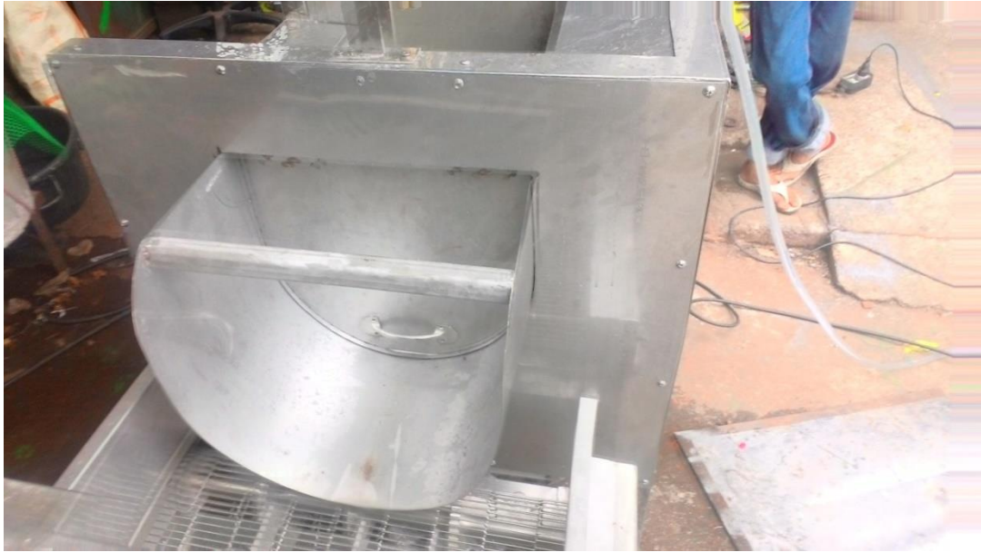
ภาพที่ 20 ช่องเชื่อมต่อสำหรับส่งมันเทศเข้าสู่คอบแห้ง
