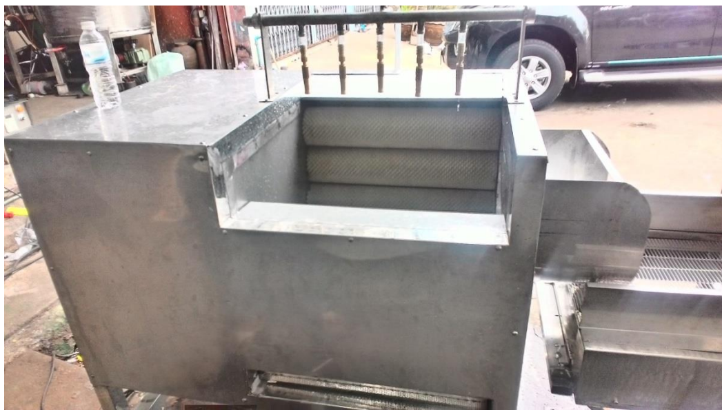
ภาพที่ 14 ภาพเครื่องล้างหัวมันเทศโดยใช้แรงดันน้ำ (ด้านหน้าช่องใส่มันเทศ)
