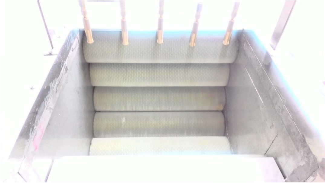
ภาพที่ 17 บริเวณจุดที่ปล่อยแรงดันน้ำและแปรงที่ใช้ร่วมกัน
