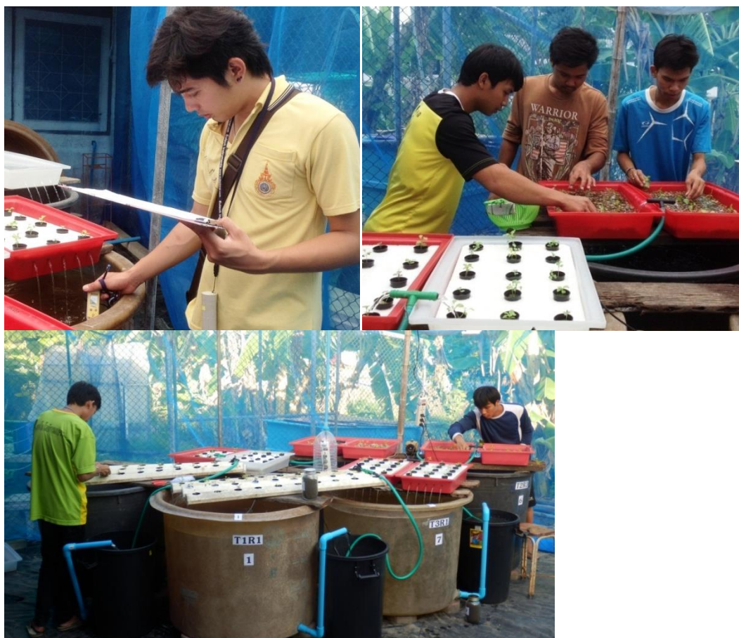
ภาพที่ 12 แสดงการติดตั้งระบบอควาโปนิค 3 รูปแบบ ที่ใช้ในการทดลองเมื่อเริ่มทำการทดลอง
