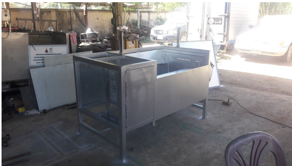
ภาพที่ 11 การประกอบโครงสร้างเครื่องจักร โดยหลังจากประกอบโครงสร้างหลักเป็นที่เรียบร้อยแล้ว ได้มีการทำสีกันสนิมและพ่นทึบด้วยสีเพื่อป้องกันไม่ให้เกิดสนิมได้โดยง่าย เนื่องจากการสัมผัสกับน้ำโดยตรงของกระบวนการทำงาน
