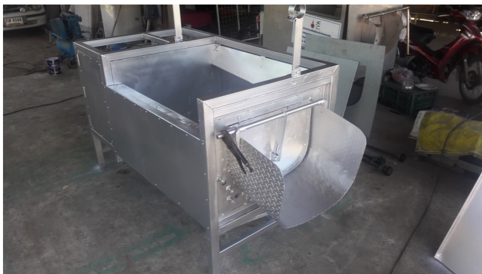
ภาพที่ 12 การประกอบทางออกของผลผลิต มีการออกแบบให้ง่ายและสะดวกต่อการใช้งานรวมถึงเพิ่มขนาดของทางออกของวัสดุให้มีขนาดใหญ่ขึ้นรองรับปริมาณการผลิตต่อครั้งที่มีมากขึ้นจากเครื่องจักรต้นแบบ
