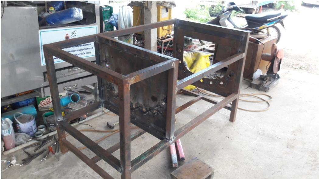
ภาพการขึ้น โครงสร้างเครื่องจักร
