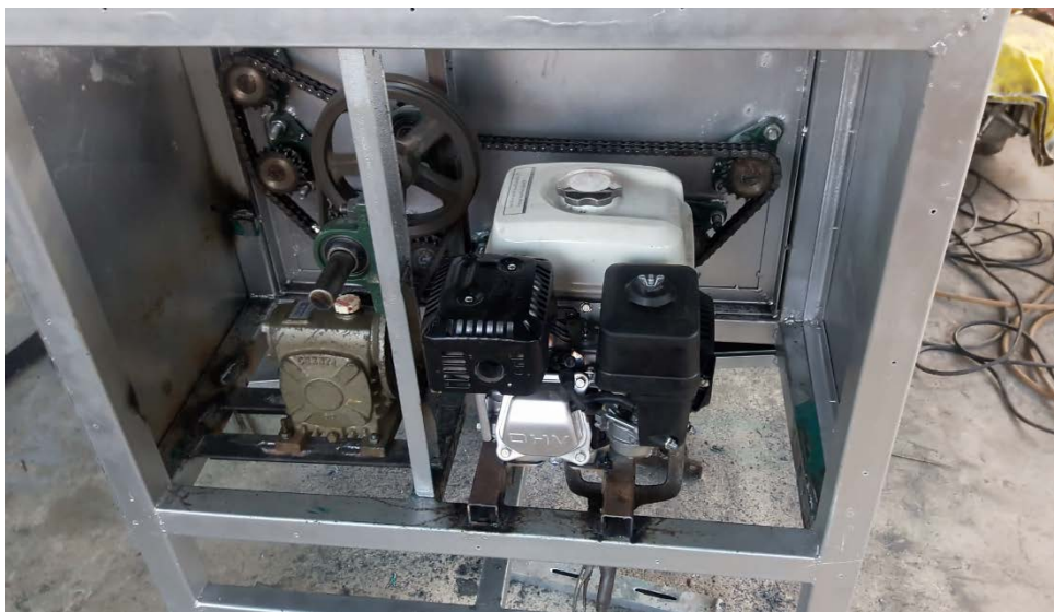
ภาพที่ 16 การประกอบชุดกลไกครั้งที่ 3 ใช้การทดเกียร์มอเตอร์เพื่อลดความเร็วของลูกขุด ซึ่งเป็นระดับที่เหมาะสมกับการทำความสะอาดมันเทศ
