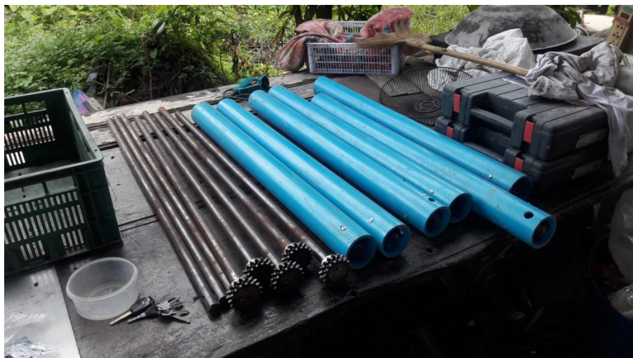
ภาพที่ 9 การประกอบแกนลูกขัด ใช้แกนเหล็กตันเชื่อมกับเฟืองเพื่อใช้ในการประกอบชุดลูกขัด โดยตัวแกน ขัดใช้ท่อ PVC ในการทำงานเนื่องจากมีน้ำหนักเบาและต้นทุนต่ำ รวมถึงการบำรุงรักษาง่าย เนื่องจากลูกขัด เป็นส่วนที่รับน้ำหนักและสัมผัสกับผิวของมันเทศโดยตรง
