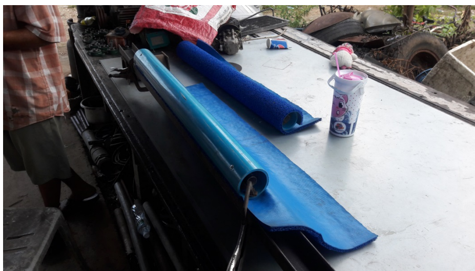
ภาพที่ 10 การประกอบพรมเพื่อใช้เป็นวัสดุในการขัด เพื่อลดต้นทุนนักวิจัยและชุมชนจึงมองหาวัสดุ ทดแทนแปรงที่มีราคาถูก จึงได้นำพรมที่ใช้กับพื้นซึ่งมีลักษณะของขนที่อ่อนและสามารถเก็บดินที่ติดบน ผิวของมันเทศได้ โดยใช้เรซินในการยึดติดระหว่างแกนลูกขัดและพรมซึ่งใช้เป็นขนของแปรงลูกขัด
