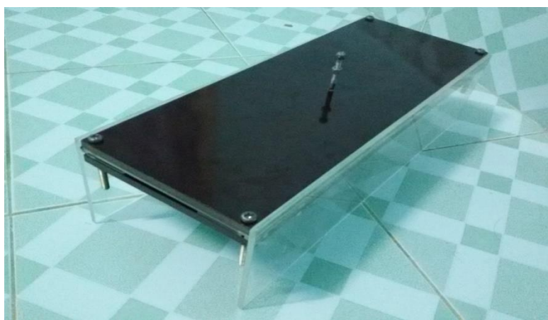
ภาพที่ 4.8 ชุดทดลองอิเล็กทรอนิกส์เพื่อสร้างสนามไฟฟ้าสำหรับวิเคราะห์ผลต่อความชื้นของเปลือกหัวในห้องปฏิบัติการที่จัดทำจากการออกแบบ
