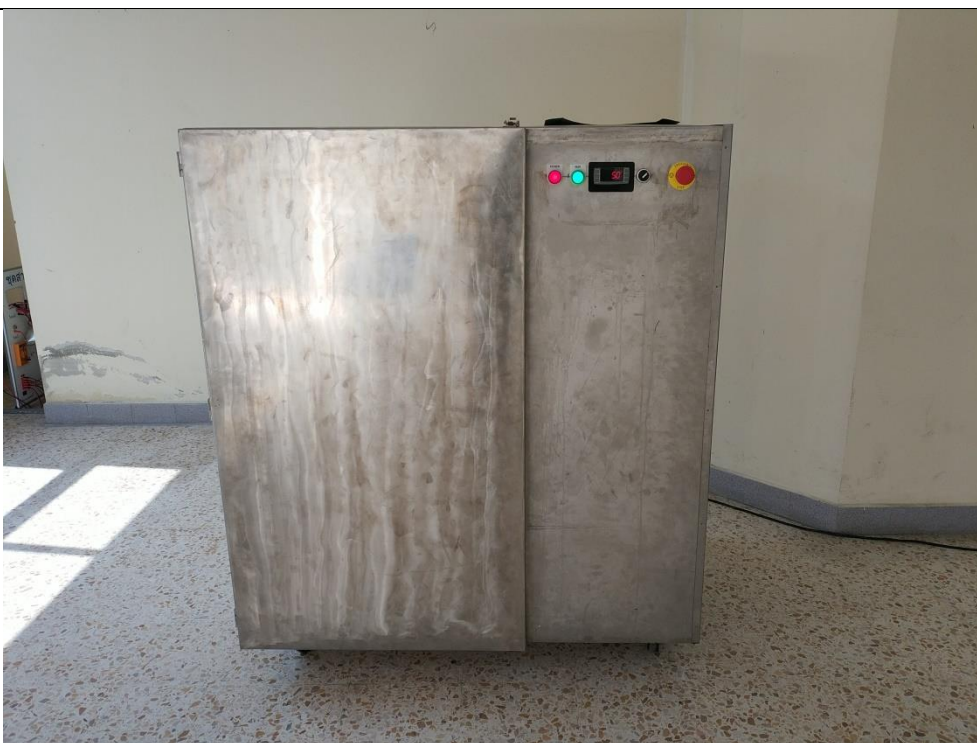
ภาพภายนอกเครื่องอบแห้งเปลือกเห็ดด้วยเทคนิคสนามไฟฟ้า ร่วมกับป้มความร้อน
