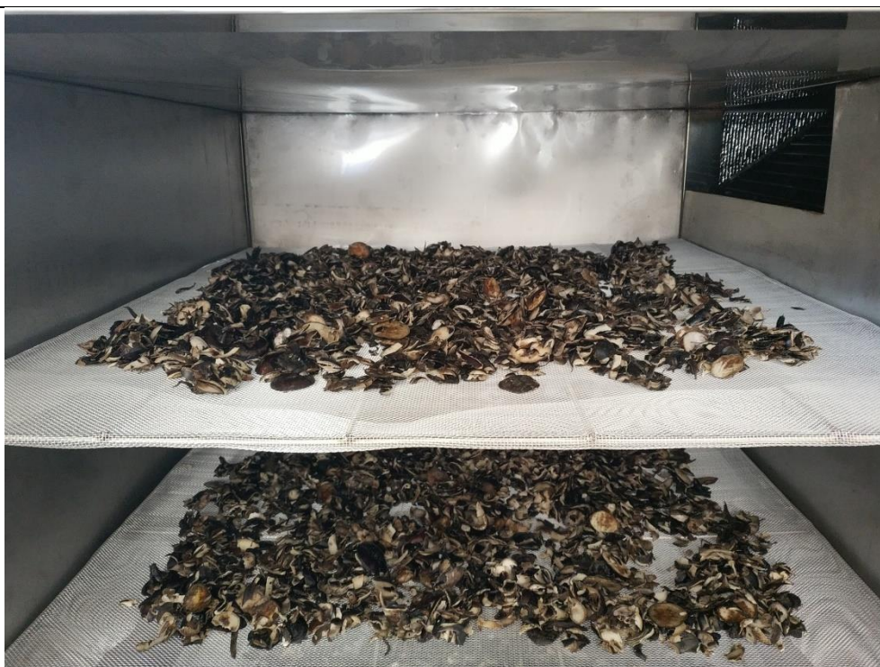
ภาพภายในเครื่องอบแห้งเปลือกหัวด้วยเทคนิคสนามไฟฟ้า ร่วมกับป้อนความร้อน
