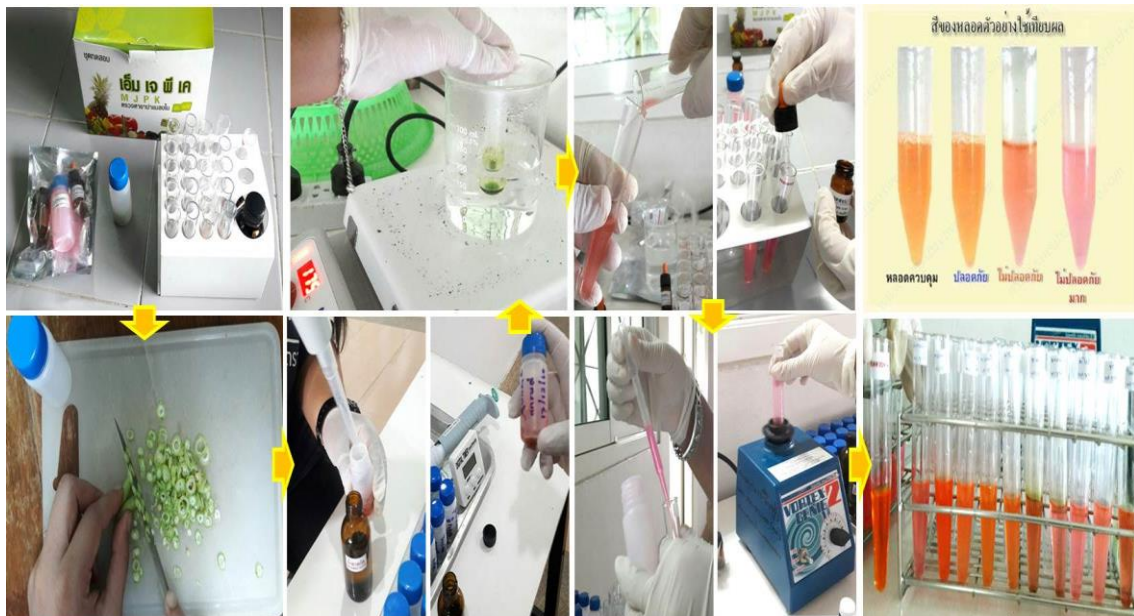
ภาพที่ ง.1 การทดสอบสารเคมีตกค้างในผักด้วยชุดทดสอบ MJPK
