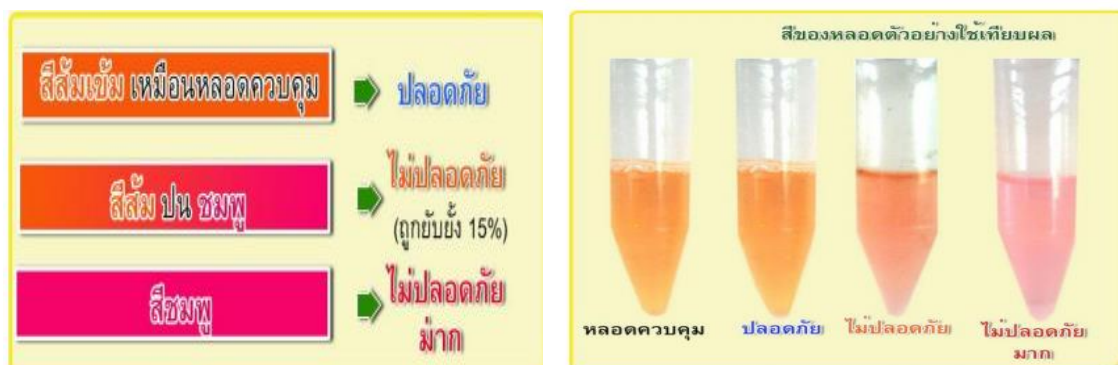
ภาพที่ ง.2 การอ่านผลชุดทดสอบหาฆ่าแมลง MJPK โดยเทียบสีกับหลอดควบคุม
